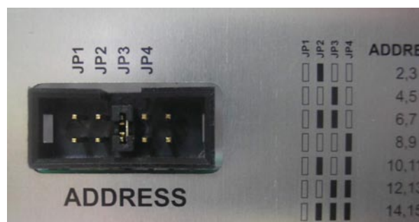
Рис. 8.1. Пример установки перемычки. Расширители, находящиеся в этом корпусе будут иметь адреса 4 и 5.
