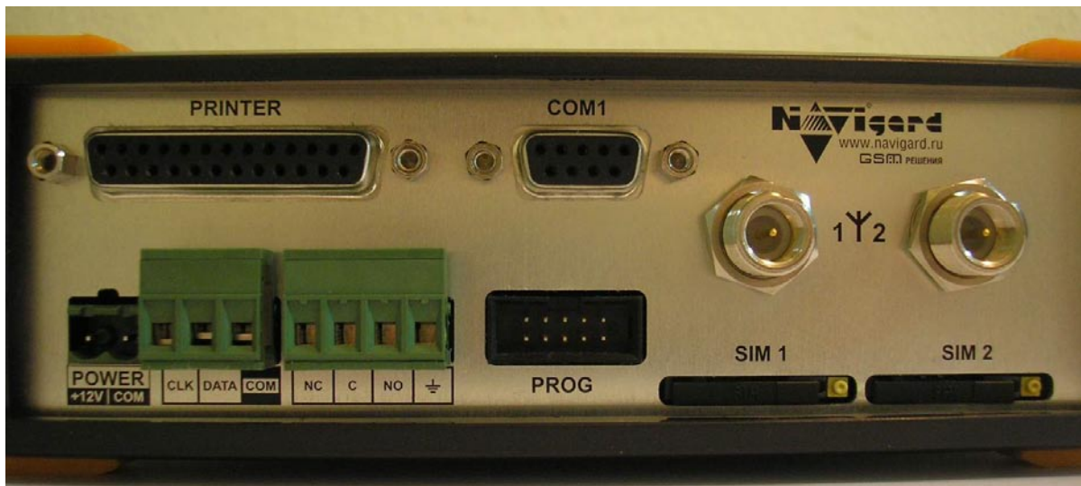
Рис. 8. GSM приемник NV DG 3220. Вид сзади.
